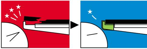
今までむき出しだったブラケットの先端の金属部分を覆う、クッション性の高い透明保護パーツ (**REC**) ができました。お客様の安全と、ガラスの破損防止のためにご検討ください。
