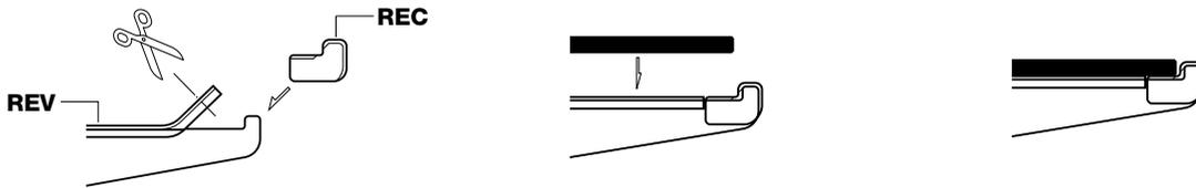
ブラケット先端保護キャップ (**REC**) は、必ずブラケットにガラスを設置する前にあらかじめ装着してご使用ください。またその際、ブラケット付属の透明クッションの位置調整や、必要に応じて長さ調整 (切断) を行って、**REV** と重なったりしない様適切にご使用ください。
