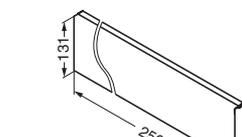
アルミプロファイル正面に取り付けるカバーです。
