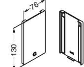
アルミプロファイルをプロファイルカバーなしで取り付けの際に使用します。左右共通です。
