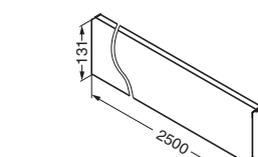
アルミプロファイル裏面に取り付けられるカバーです。
