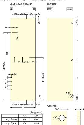
キャビネット内に扉を収納する仕様の場合…EH= キャビネット高さ内寸法 建設空間に直接取り付ける仕様の場合…EH= 天地高さ - 4
