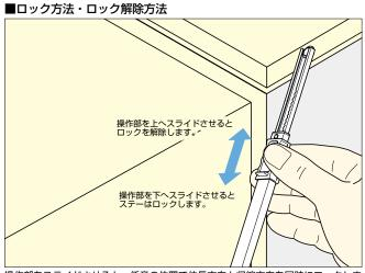
操作部をスライドさせると、任意の位置で伸長方向と収縮方向を同時にロックしま す。
