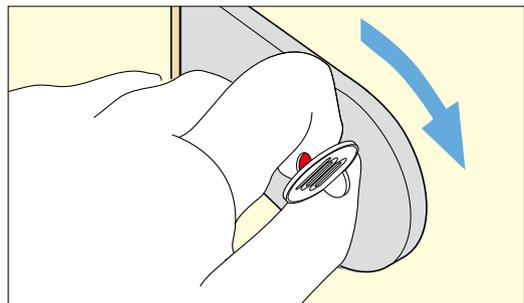
表示器には緊急時に、室外から開錠できる機能が付いています。上図のように、中心部をコインなどで90°回転して開錠します。
