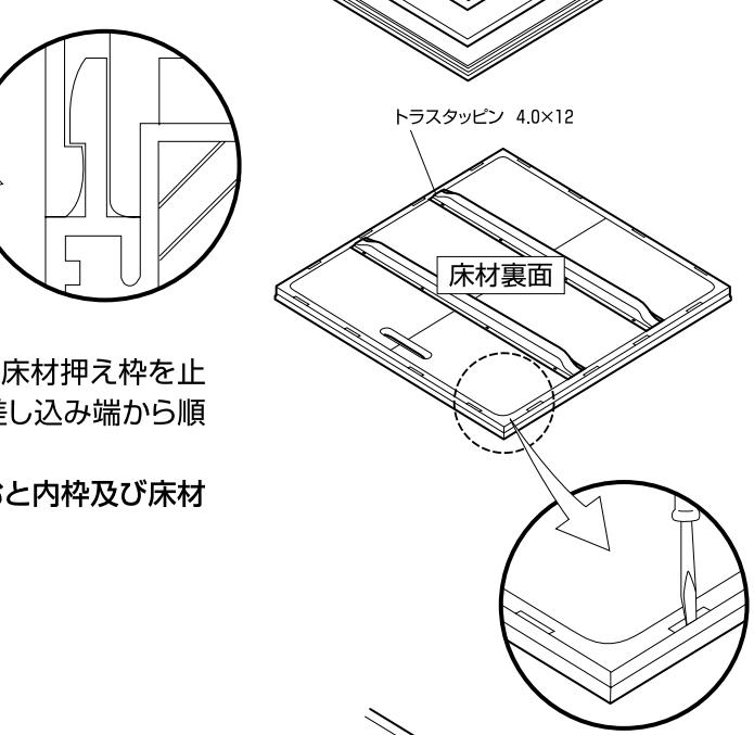
☆床材押え枠取り外し方法
